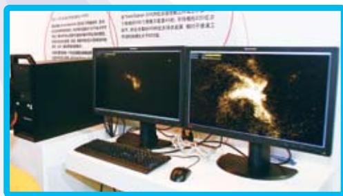
可实现每秒 1 万亿次浮点运算最高速度的 ThinkStation D10 计算机 The computer's maximum operational speed reaches 1 trillion floating-point times per second
